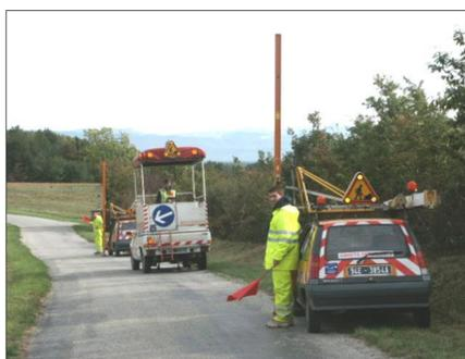
Figure 2 : La technique du nivellement motorisé
